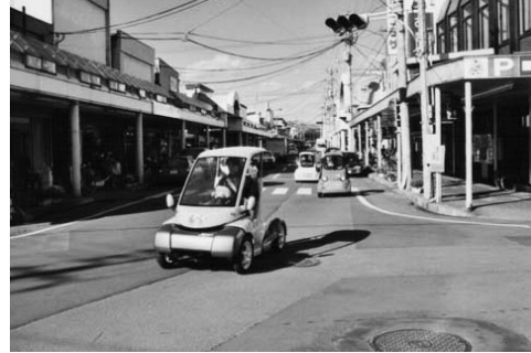
シルバービークルは、加齢により運動能力が衰えても自由に移動できる手段として考えられた小型電気自動車。最高時速30kmで、乗車には普通免許が必要だが、すべての操作が手元でできる。写真は秋田県で行われたモニターによる走行実験中のシルバービークル。
